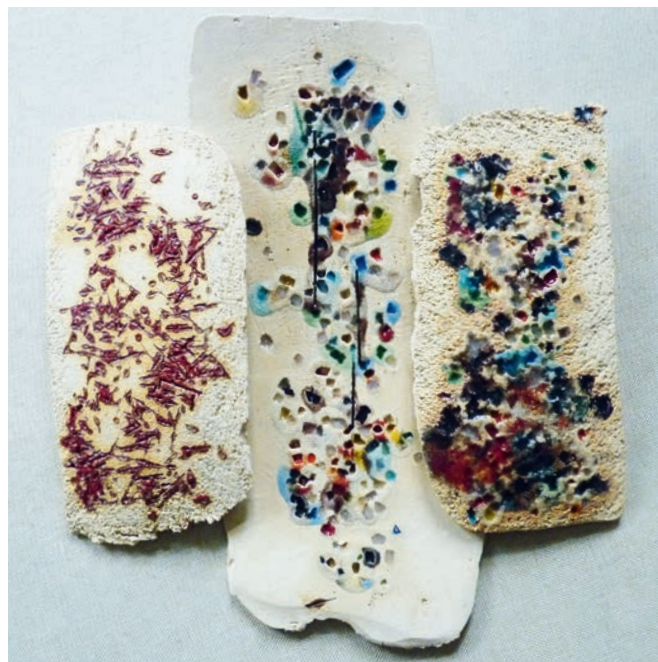
Tonplatten mit Glasgranulat und Glasfäden bei 1100°C gebrannt.
